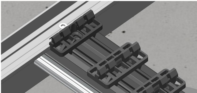
Wenn an den Stirnseiten eine Aluminiumblende angebracht wird, kann es erforderlich sein, den Clip am Ende der Schiene durch einen Halbclip zu ersetzen, damit die Blende nicht gegen den Clip stößt.
